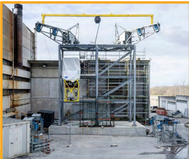
Robot para instalación de fachadas (en este caso un muro cortina).
