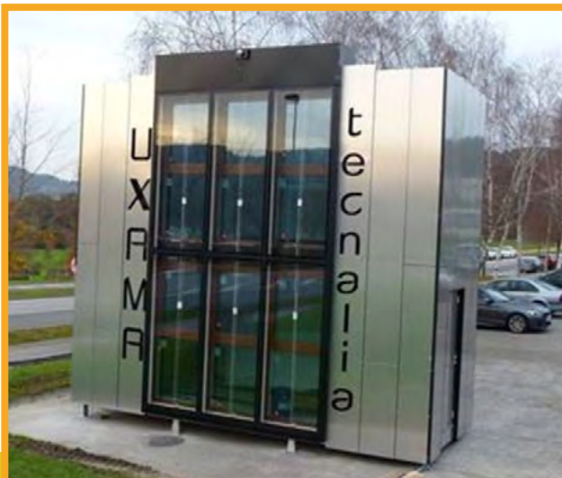
Envolvente activa. Muro cortina de doble envolvente para el precalentamiento del aire de ventilación de un edificio
