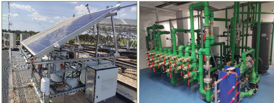
Ilustración 17. Banco de ensayos PVT y Banco de ensayos Bombas de calor agua-agua de CARTIF. Fuente: CARTIF
